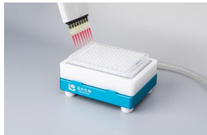
2. 加入需要过滤的样品，并启动负压装置的真空泵，负压过滤。
