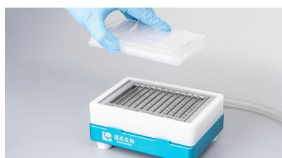
3A. 样品都抽滤完成以后，关闭真空泵，并释放负压装置里面的真空，移走滤板和剩余样本。
