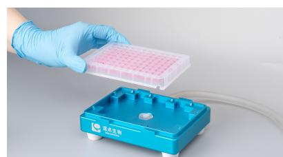
3B. 卸下负压装置的上层托架，并取出下层含有样品滤液的收集板，以便将样品进一步处理。
