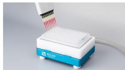
2. 往过滤板中加入需要过滤的样品，样品添加完成后在过滤板顶部盖上盖板或者硅胶垫，并启动连接负压装置的真空泵，开始进行负压过滤。
