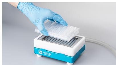
1. 将过滤板置于负压装置上，使过滤板的底边紧贴负压装置的硅胶密封条。
