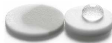
亲水性筛板，水滴很快渗入筛板； 疏水性筛板，必需加压，否则水滴不能渗入筛板。
