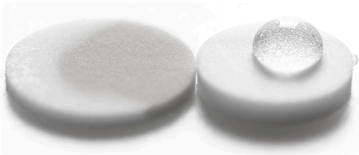
疏水性筛板，必需加压，否则水滴不能渗入筛板。
