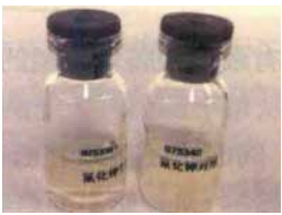
氰化钾试验阳性 (试验管和对照管浑浊)
