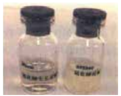
氰化钾试验阴性 (试验管澄清，对照管浑浊)
