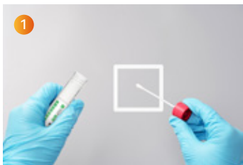
使用无菌规格板固定待检区域
