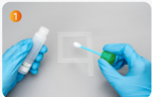
使用无菌规格板固定待检区域
