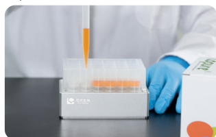
步骤 1 吸取样品上清液至 Copure® 24 孔农残净化板中净化样本
